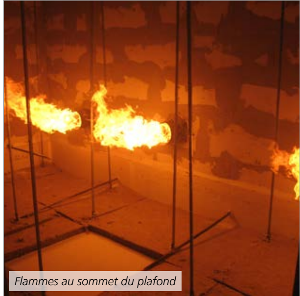
Capteur de température conforme à la norme EN 1364-2
