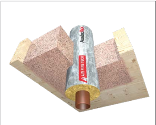
Metalen buizen afgesloten met BRANDBESCHERMING
