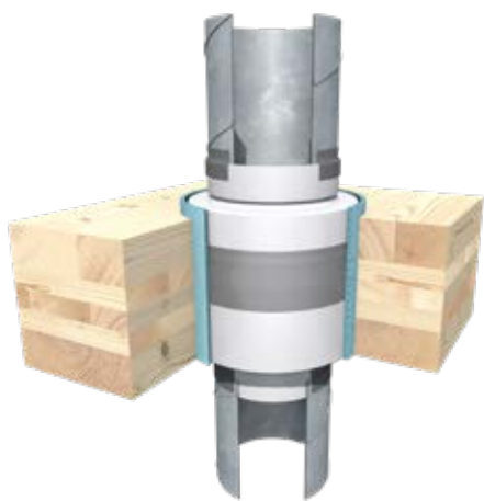
PRODEC en plafond en bois massif contreplaqué de 140 mm avec isolation PE de 5 mm
