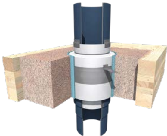
PRODEC in 140 mm TIROTECH®-brandwerende mortel met 5 mm contactgeluidisolatie
