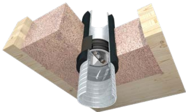
FSAeco izmanto izolētajā gaisa vadā
