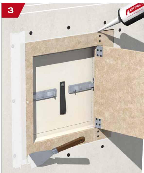
3 Ringspalt mit Fugenfüller oder Brandschutzfugenmasse ausfüllen. Bewehrungsstreifen anbringen und Spachtelung durchführen.
