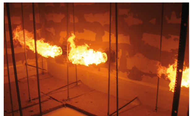
Intensité d'incendie du plafond côté supérieur (a→b)
