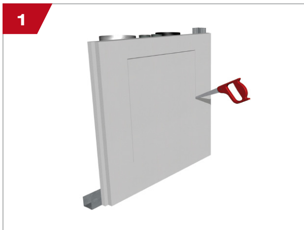
Préparation de l'ouverture dans le mur
