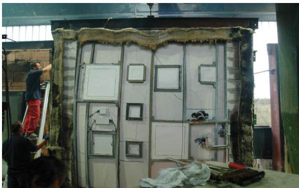
Intensité de l'incendie côté gaines (i→o)
