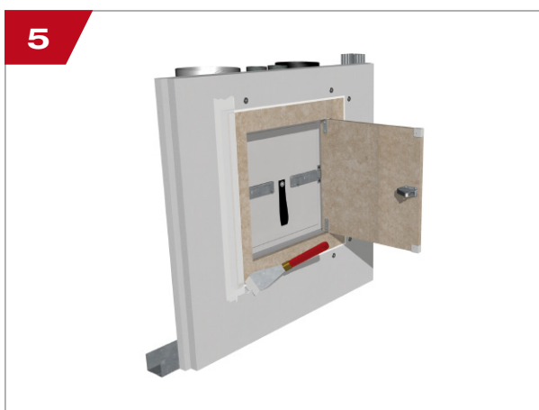
Apposer les bandes d'armature et lisser à la spatule
