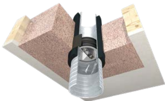
FSAeco inbouw in geïsoleerd luchtkanaal
