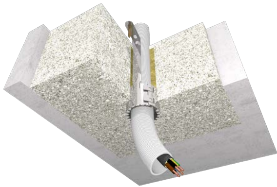
RORCOL AV60 eingesetzt mittels Montagehilfe MH/RORCOL
