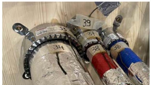
La norme d'essai EN 1366-3 spécifie les méthodes d'essai et des critères pour l'évaluation de l'aptitude d'un calfeutrement à maintenir la résistance au feu d'un élément séparatif à l'endroit auquel il est traversé par un ou plusieurs traversants.
