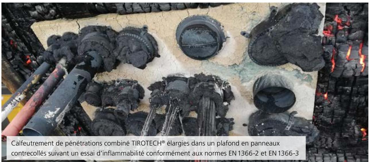
Calfeutrement de pénétrations combiné TIROTECH® élargies dans un plafond en panneaux contrecollés suivant un essai d'inflammabilité conformément aux normes EN 1366-2 et EN 1366-3
